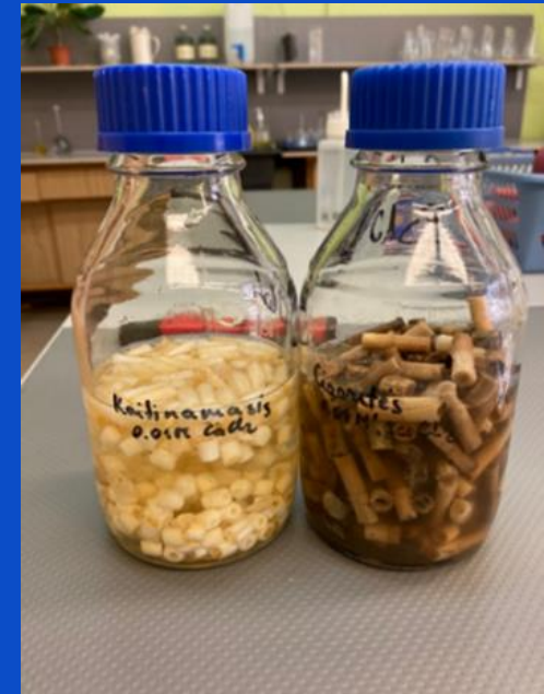
3 pav. Kaitinamųjų lazdelių filtrų ir cigarečių filtrų eliuato paruošimas naudojant 0,01 M \text{CaCl}_2
