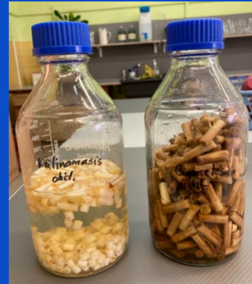
2 pav. Kaitinamųjų lazdelių filtrų ir cigarečių filtrų eliuato paruošimas naudojant distiliuotą vandenį
