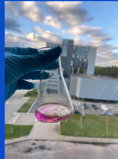
Nutitruotas tiriamasis mėginys su KMnO_4 tirpalu iki rožinės spalvos
