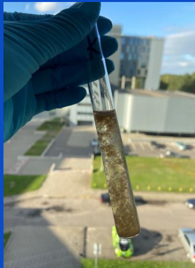
Veikliojo dumblo suspensijos mišinys po 30 min. išlaikymo sumaišytas su 10 % H_2SO_4 tirpalu
