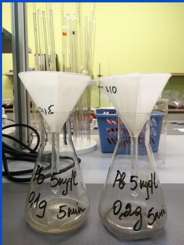
7 pav. Vandeninių tirpalų filtravimas naudojant „VWR Qualitative filter paper 413“ filtrinį popierių
