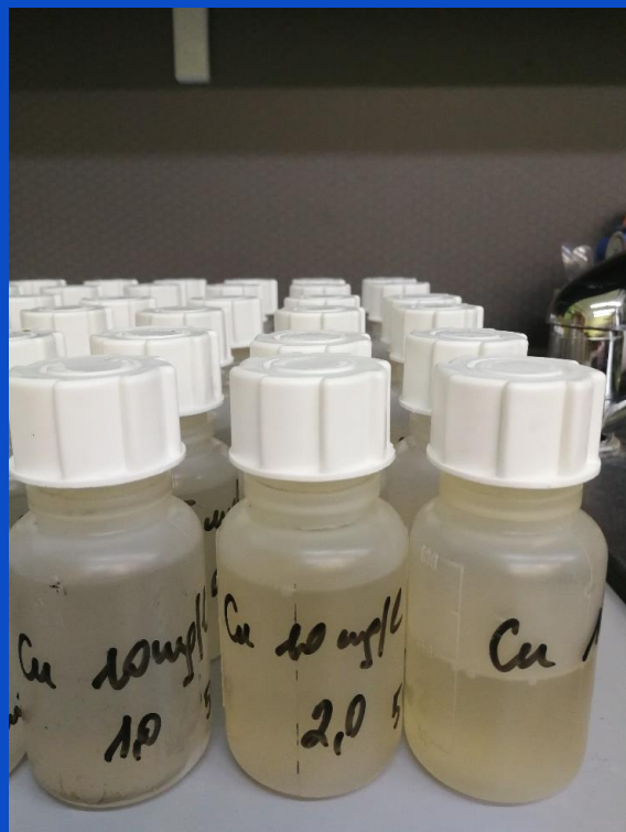
9 pav. Paruošti mėginiai tyrimui su atominės adsorbcijos spektrinės analizės prietaisu
