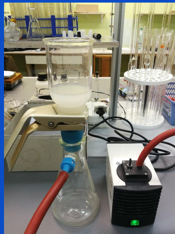
8 pav. Vandeninių tirpalų filtravimas naudojant vakuuminį siurbį
